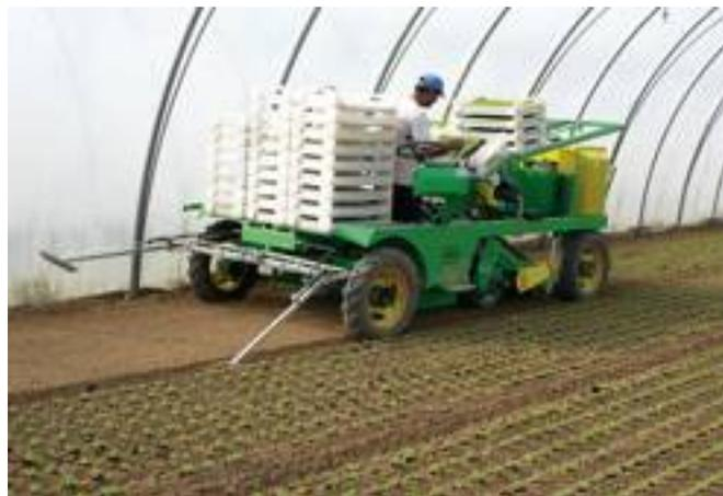
**Le moderne trapiantatrici sono in grado di seguire da sole il tracciato della baulatura e richiedono un solo operatore a bordo, con sostanziale riduzione della manodopera.**
