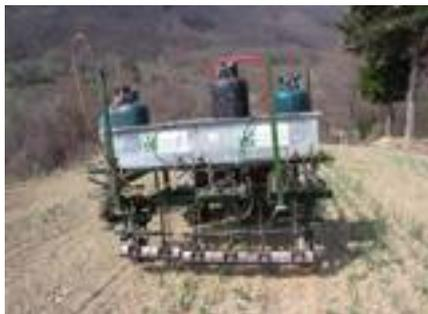
**Operatrice per il pirodiserbo durante il controllo delle infestanti in post-emergenza su aglio di Vessalico in alta Valle Arroscia.**
