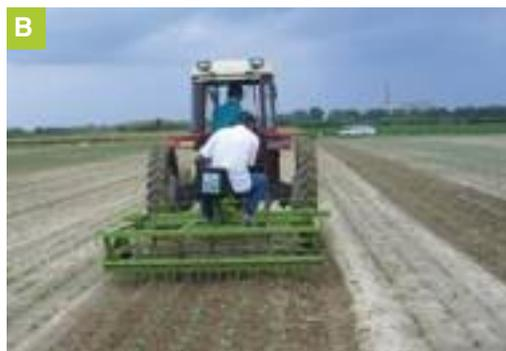
**Erpice a dischi attivi utilizzato per la sarchiatura precoce dello spinacio: (A) prima versione del prototipo impiegata su coltura seminata a file strette (interfila pari a 20 cm); (B) seconda versione del prototipo equipaggiata con denti elastici operanti sulla fila e sistema di guida manuale in lavoro su spinacio seminato a file larghe (interfila pari a 40 cm).**
