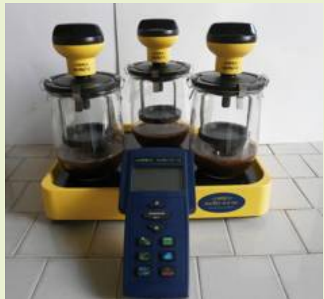
Foto 1 - Dispositivo completo per la misurazione del tasso di assorbimento dell'ossigeno (OUR): agitatore magnetico, contenitori con trasduttore di pressione e controller agli infrarossi (foto Crippa).
