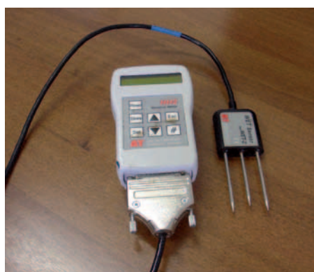
Sonda portatile per misura di volume d'acqua, EC, temperatura substrato (Cnr-Isipa).
