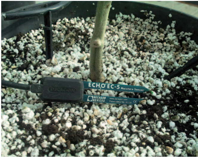
Sonda per la determinazione dell'umidità volumetrica del substrato mediante la misura della costante dielettrica.
