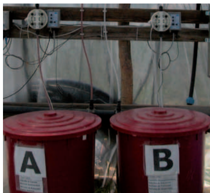
Serbatoi per la preparazione delle soluzioni concentrate per fertirrigazione in serra fuori suolo (foto Cnr-Ispa).
