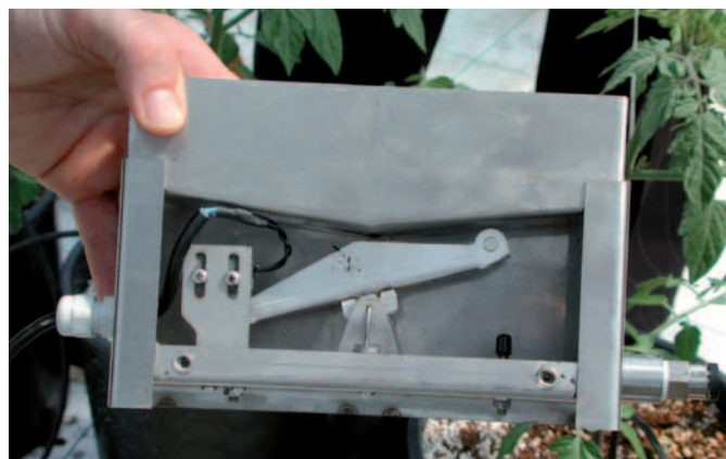
Sistema automatico di monitoraggio del drenato. Può essere collegato a un fertirrigatore per adeguare la fertirrigazione alle esigenze della pianta (foto Cnr-Ispa).
