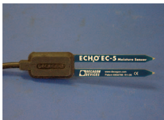
Moderna sonda per la misura del volume di acqua nel substrato (foto Cnr-Isipa).
