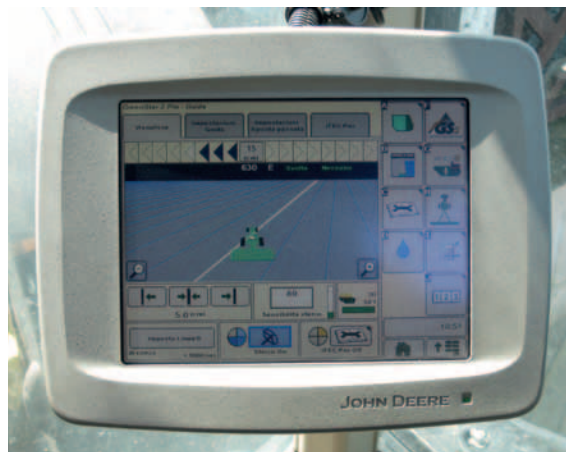
Il sistema di guida automatica mantiene esattamente parallele le passate con una minima sovrapposizione, risparmio di tempo e senza sprechi di carburante.
