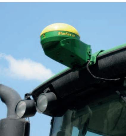
Particolare di un ricevitore satellitare Gps collegato al trattore.
