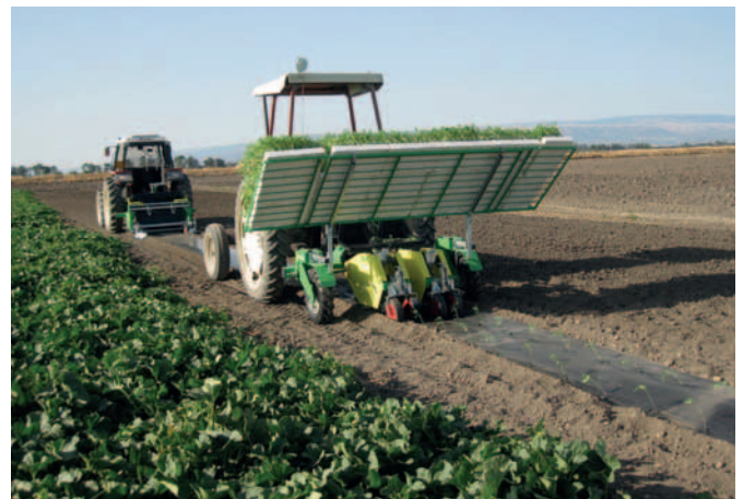
Macchina per la stesura del telo pacciamante e macchine per il successivo trapianto, nella pianura foggiana.
