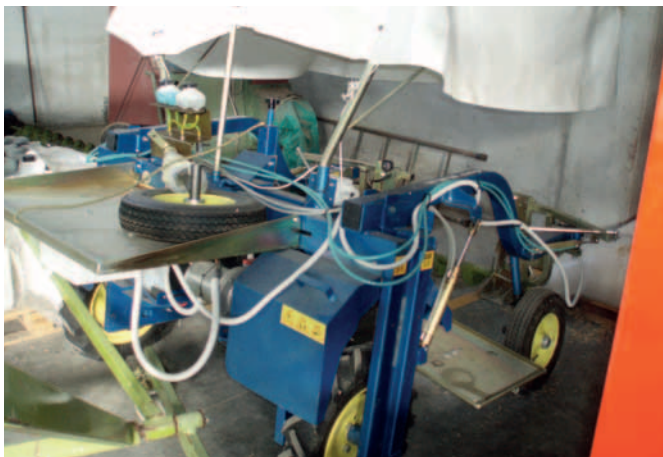
Macchina agevolatrice per la raccolta dell'asparago in riparazione nell'officina della cooperativa Giardinetto.
