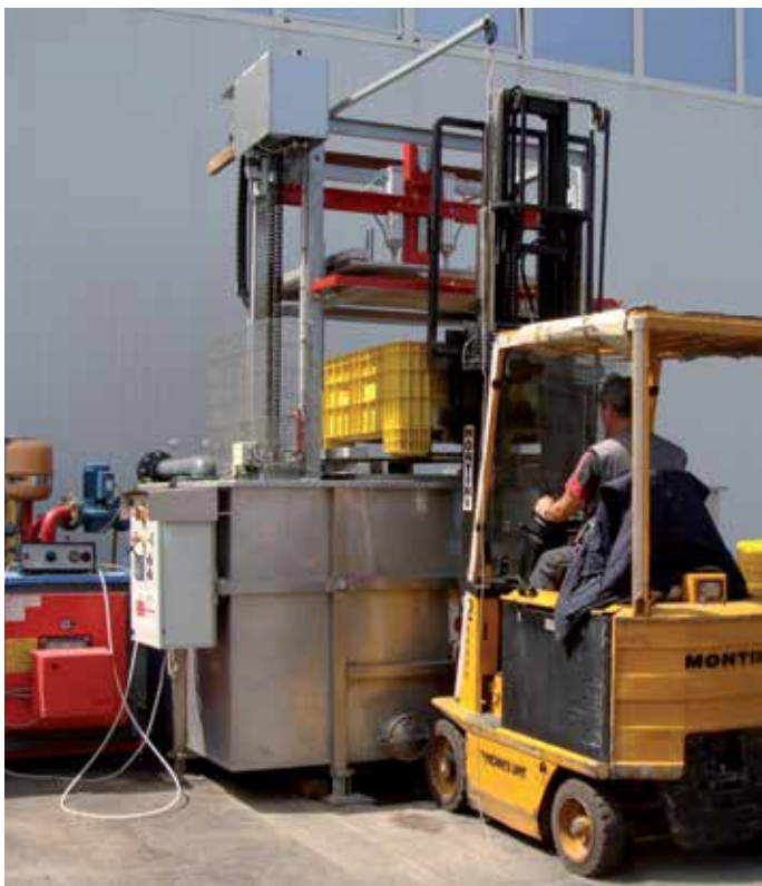
▲ Fig. 3 - Prototipo di macchina per i trattamenti di termoterapia a livello commerciale (Xeda International, S. Andiol, Francia).
