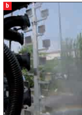
[ Controllo funzionale rispettivamente di (a) un atomizzatore e (b) una barra irroratrice.
