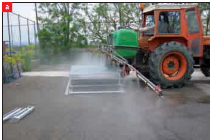
[ Controllo funzionale rispettivamente di (a) un atomizzatore e (b) una barra irroratrice.
